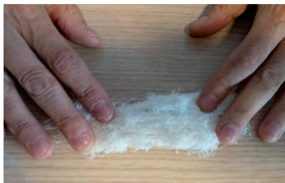
Tessuto di Nylon prima del processo, si può vedere la sua elasticità dovuta all'elastomero contenuto nelle fibre
